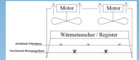
Durch den Einsatz unserer speziell entwickelten Nebeldüsen wird die Oberfläche des Wasser auf das ca. 1000 fache vergrößert und beschleunigt die Verdunstung bzw. den Temperatureaustausch enorm.
